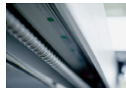
Motoricky nastaviteľný šírkový doraz, s digitálnym ukazovateľom s presnosťou 0,1mm
